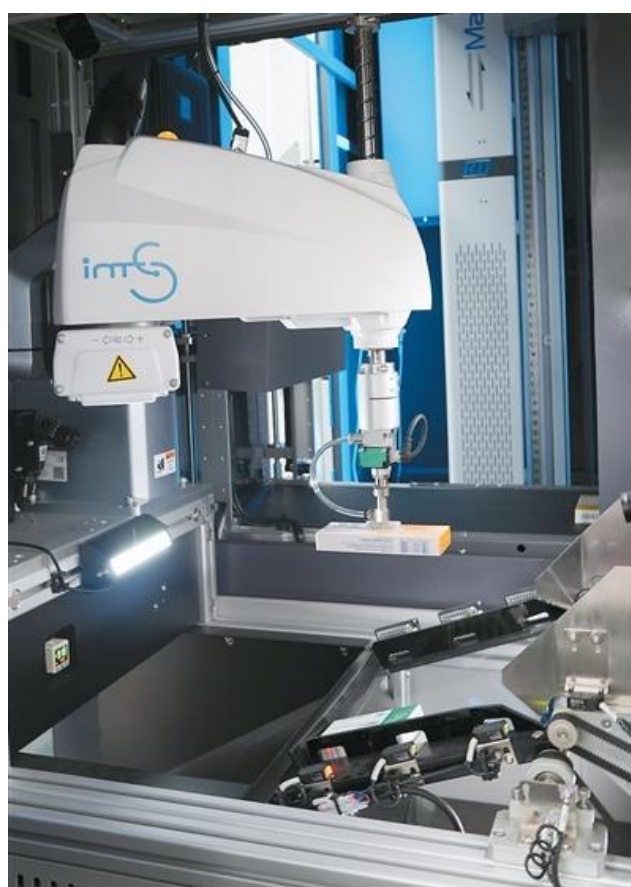
北京安贞医院通州院区住院药房内，药品分拣机器人借助吸盘分拣药品。
